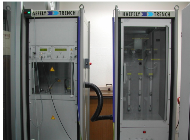
เครื่องกำเนิดรูปคลื่นผสม 1.2/50 \mu\text{s} & 8/20 \mu\text{s}
