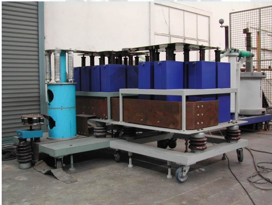
ข) เครื่องกำเนิดกระแสอิมพัลส์ ขนาด 150 kA 55 kJ หลังการปรับปรุง
