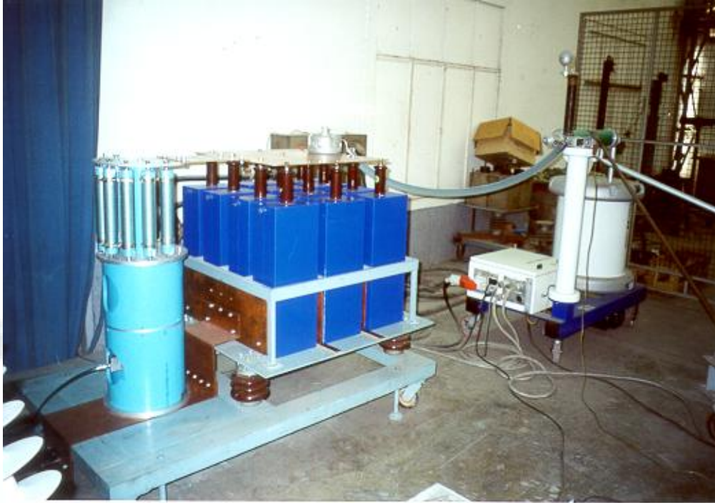
ก) เครื่องกำเนิดกระแสอิมพัลส์ ขนาด 75 kA 30 kJ ก่อนการปรับปรุง
