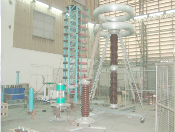
เครื่องทดสอบแรงดันอิมพัลส์น้ำหนักลิ้นชัก
