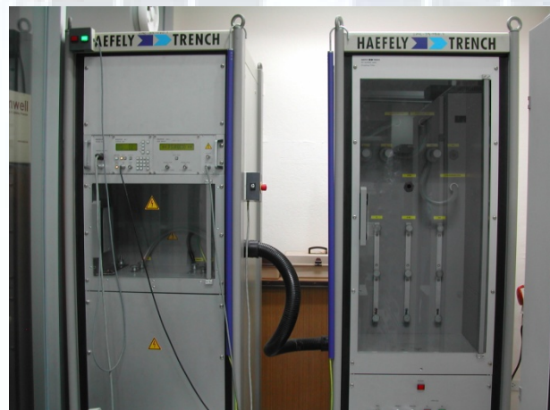
เครื่องกำเนิดรูปคลื่นผสม 1.2/50 \mu s & 8/20 \mu s
